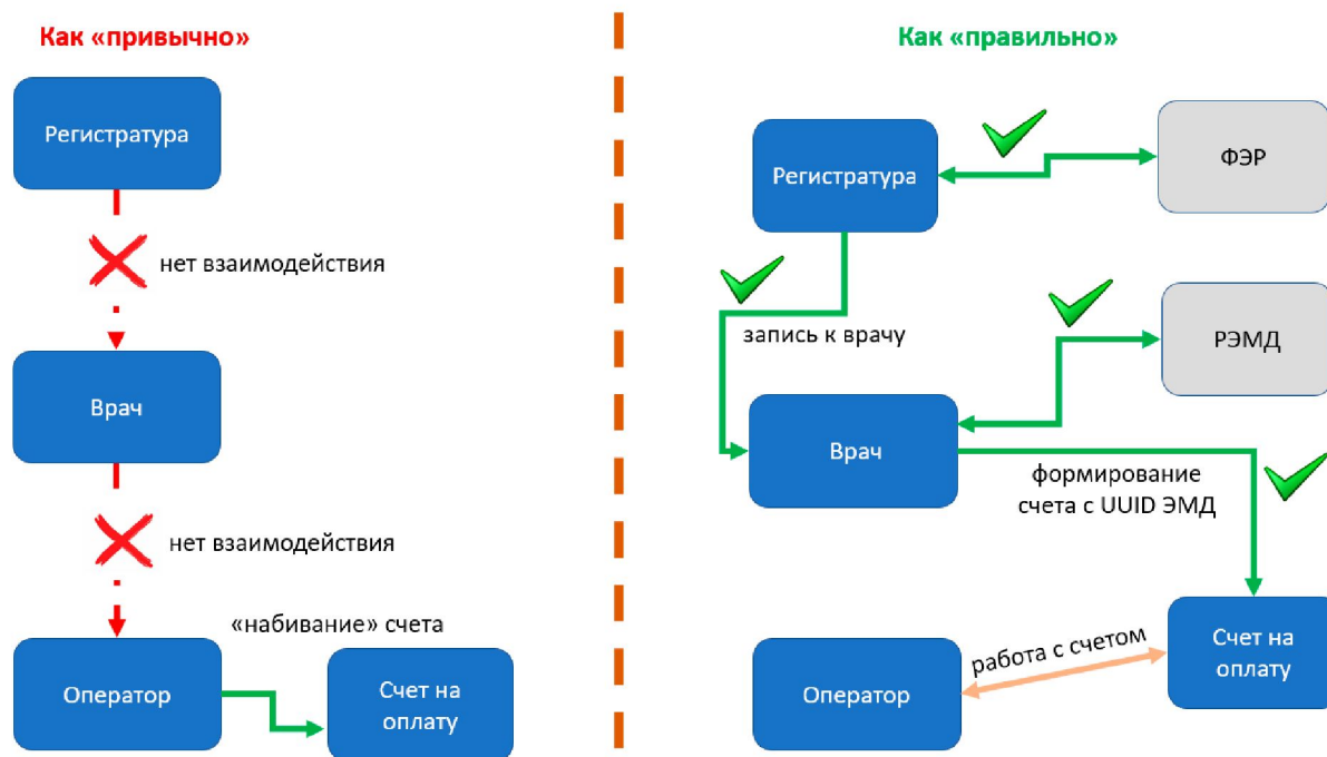
Рис. 5. Схема взаимодействия при автоматизированном выставлении счетов
